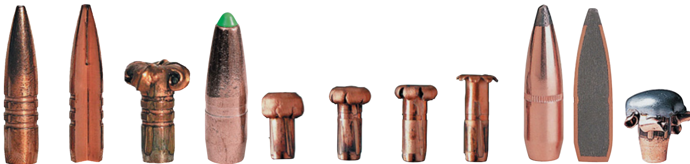
Характер деформирования: слева изображена пуля Barnes TSX, а также её разрез и конечный вид после попадания в цель, затем идёт Naturalis и деформировавшиеся пули при различных скоростях встречи с целью. Крайняя справа – Sierra Game King.
